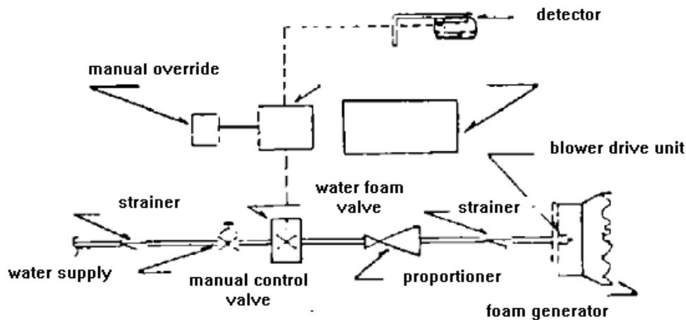
**BLOCK DIAGRAM OF AUTOMATIC MEDIUM-OR HIGH-EXPANSION FOAM SYSTEM Fig. 12**
