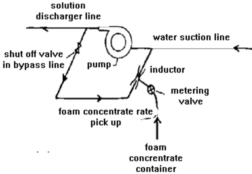
**AROUND -THE -PUMP PROPORTIONING SYSTEM TYPICAL ARRANGEMENT Fig. 7**
