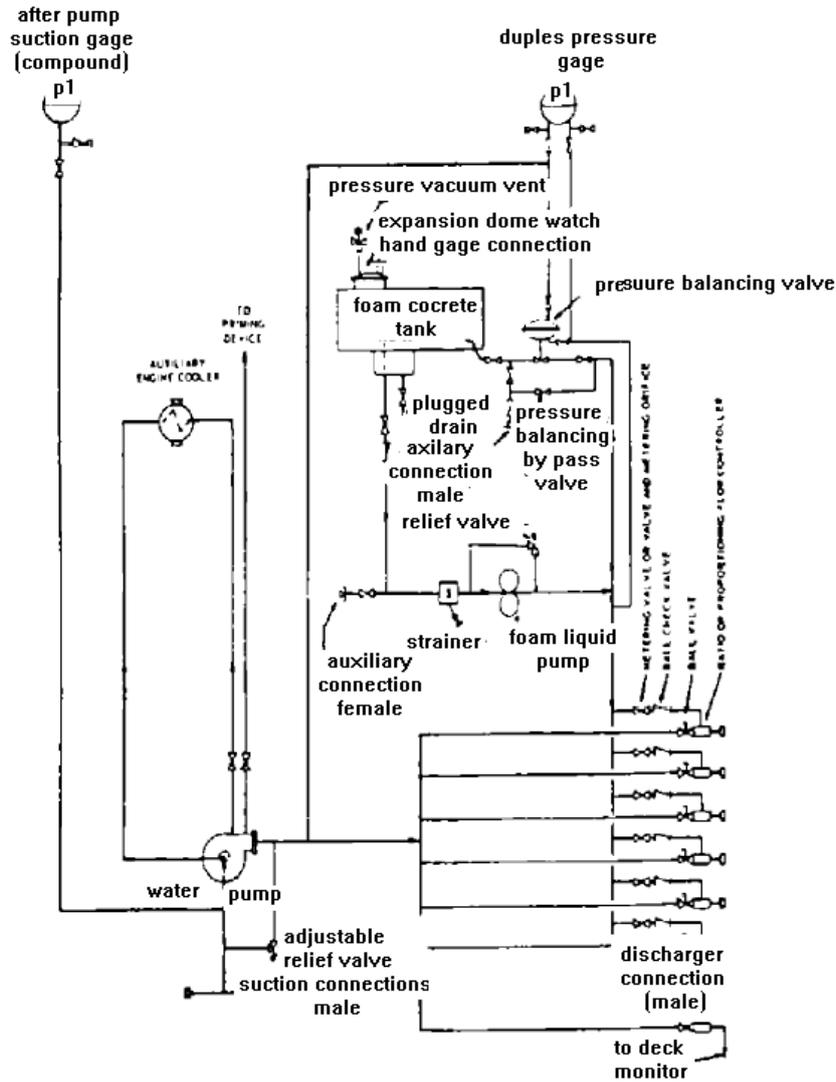
TYPICAL BALANCED PRESSURE PROPORTIONING SYSTEM
