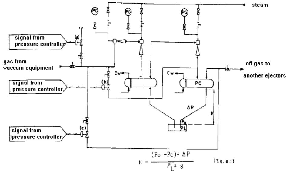
TYPICAL P & I DIAGRAM FOR STEAM EJECTORS VACUUM SYSTEM
