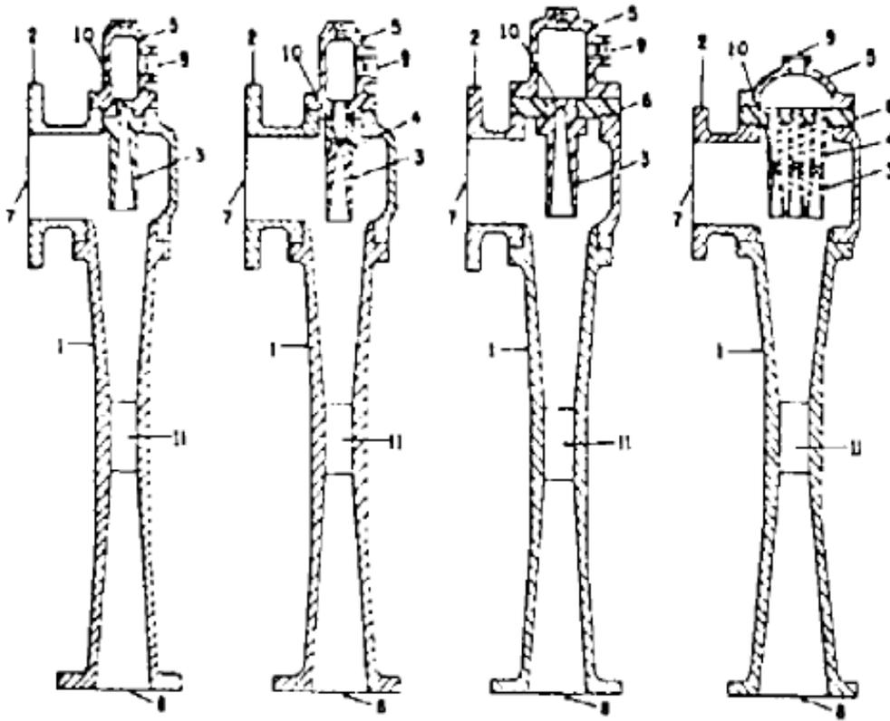
TYPICAL STEAM JET EJECTOR STAGE ASSEMBLIES
