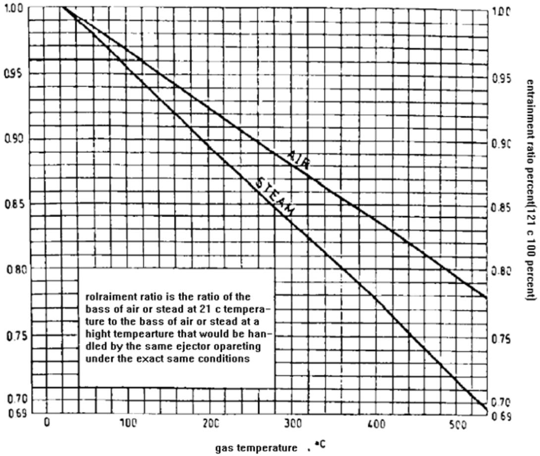
TEMPERATURE ENTRAINMENT RATIO CURVE
