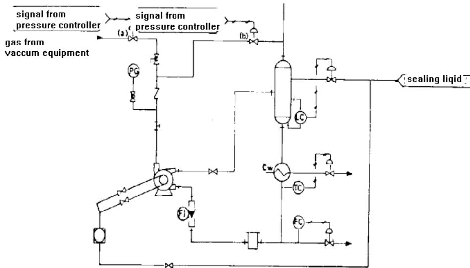
TYPICAL P & I DIAGRAM FOR VACUUM PUMP SYSTEM
