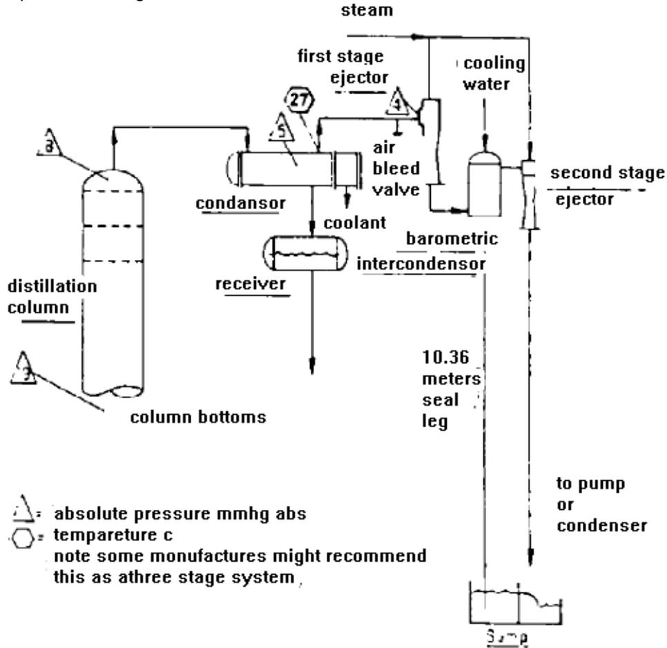
VACUUM SYSTEM FOR DISTILLATION
