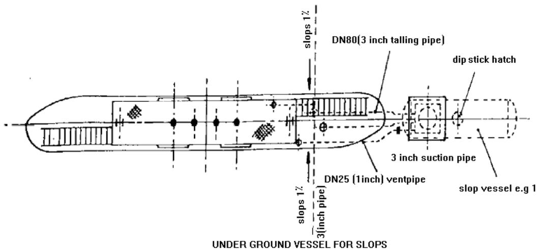
TYPICAL UNDERGROUND VESSEL FOR SLOPS, WITH CLOSED DRAINAGE FLOW SCHEME
