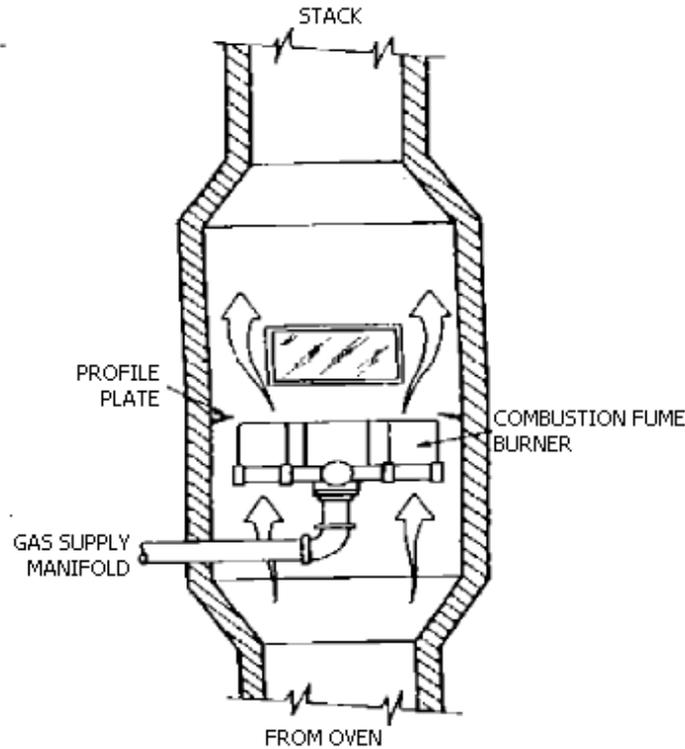
**DUCT TYPE FUME BURNER**
