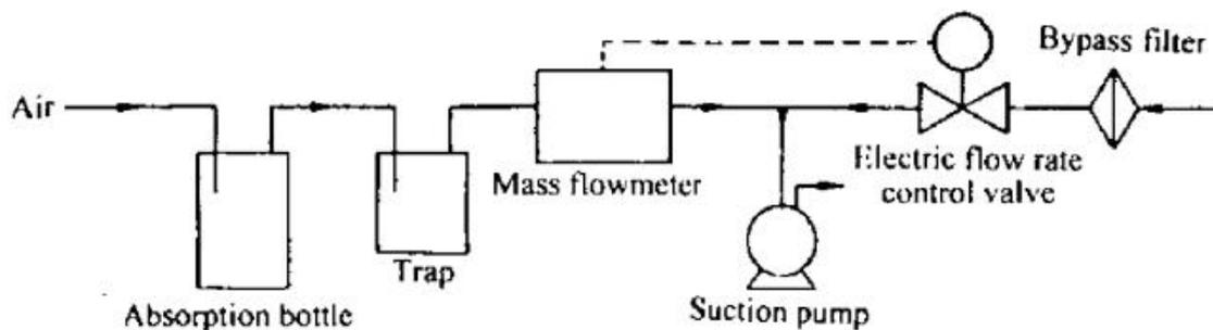
ADSORPTION PROCESS SCHEME FOR GAS ADSORPTION
