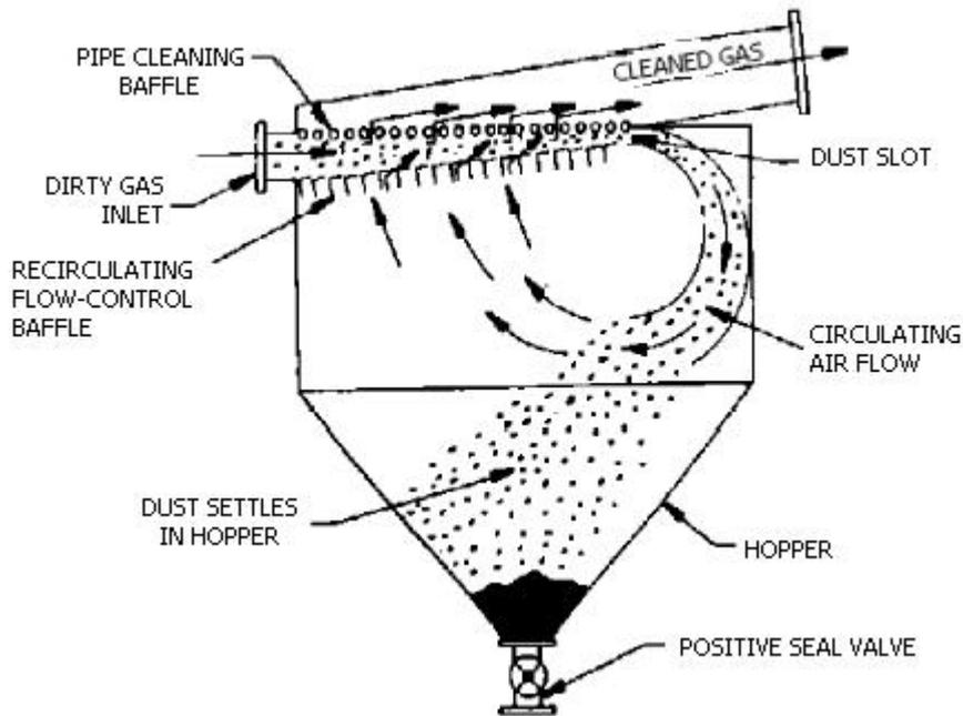
**RECIRCULATING BAFFLE COLLECTOR**
