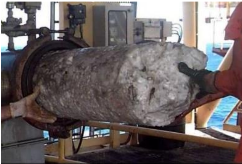
شکل ۶: یک توپی بزرگ تشکیل شده در مسیر انتقال مواد نفتی در زیر دریا (عکس از Petrobras برزیل)
